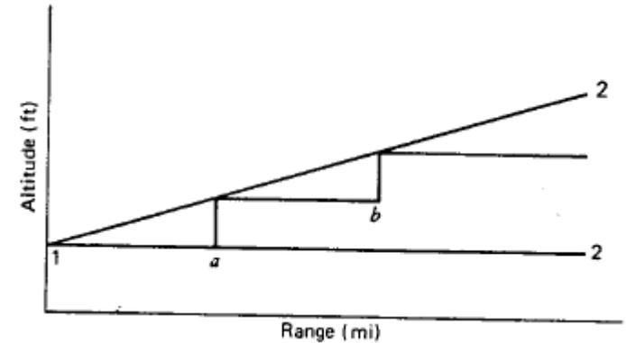
Tipicamente gli step ammessi dagli enti controllo traff aereo sono di 40 FL o 20 FL (1 FL = 100 ft) e dispari e pari per sensi opposti di direzione di volo.
