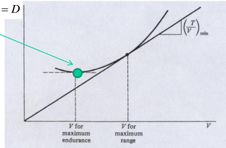
*La massima autonomia di durata di un velivolo a getto si ottiene con un volo ad una velocità tale che il rapporto  $C_L / C_D$  sia massimo.*
