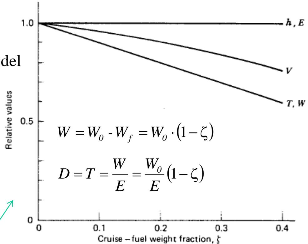
**Come già visto, tale crociera prevede Velocità TAS (e quindi Mach) variabile in diminuzione, mano a mano che si consuma carburante, fino al valore finale della frazione utile. Si nota che anche la resistenza (e quindi la spinta necessaria) si riducono con il peso (l'assetto e quindi l'efficienza sono costanti).**
